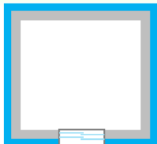
外壁の断熱改修 (断熱材＋通気層分が増加)
